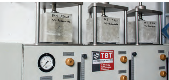
Prüfvorrichtung zum Aufbauen von Wasserdruck, DIN EN 12390-8
