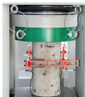
Links: Festbetonprüfung an Würfel und Zylinder Mitte: E-Modulprüfung mit graphischer Auswertung Rechts: Haftzugprüfung (servohydraulisch), Oberflächenzugfestigkeit nach DIN EN 13813 - digitale Auswertung
