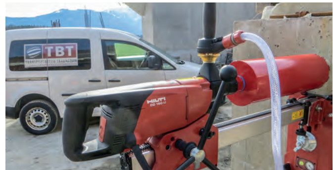
Bohrkernentnahme bis 40 cm Tiefe, verschiedene Durchmesser
