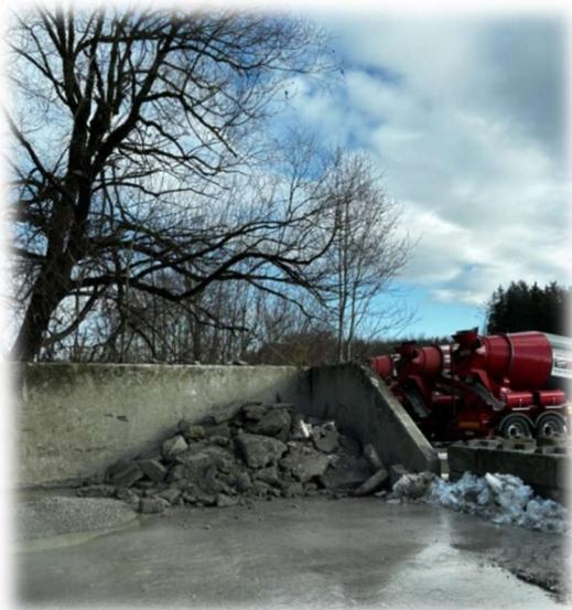
Unser anfallender Rück- bzw. Restbeton, welchen wir zunehmend reduzieren, wird in zwei Arten unterschieden. Zum einen haben wir verschiedene Formen zur Herstellung von Betonblöcken, zum anderen ein Haufwerk mit Restbeton, welcher gebrochen wird und dadurch wieder im Beton eingesetzt werden kann.
