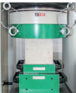
Links: Festbetonprüfung an Würfel und Zylinder Mitte: E-Modulprüfung mit graphischer Auswertung Rechts: Haftzugprüfung (servohydraulisch), Oberflächenzugfestigkeit nach DIN EN 13813 - digitale Auswertung
