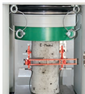
Links: Festbetonprüfung an Würfel und Zylinder Mitte: E-Modulprüfung mit graphischer Auswertung Rechts: Haftzugprüfung (servohydraulisch), Oberflächenzugfestigkeit nach DIN EN 13813 - digitale Auswertung
