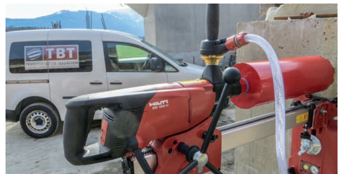
Bohrkernentnahme bis 40 cm Tiefe, verschiedene Durchmesser
