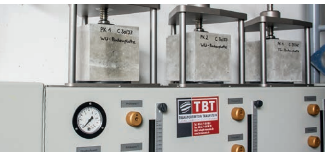
Prüfvorrichtung zum Aufbauen von Wasserdruck, DIN EN 12390-8
