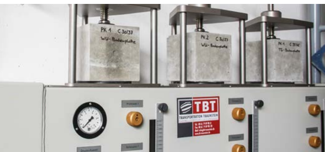
Prüfvorrichtung zum Aufbauen von Wasserdruck, DIN EN 12390-8
