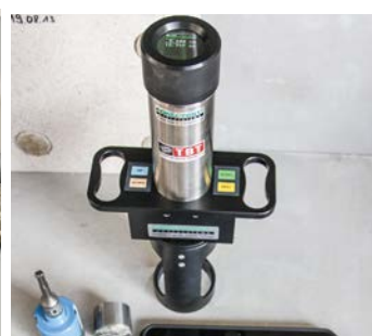
Links: Festbetonprüfung an Würfel und Zylinder Mitte: E-Modulprüfung mit graphischer Auswertung; Rechts: Haftzugprüfung (servohydraulisch), Oberflächenzugfestigkeit nach DIN EN 13813 - digitale Auswertung.
