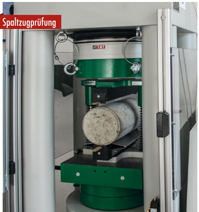
Ermittlung der Spaltzugfestigkeit (Kennzahl zur Bewertung der Zugfestigkeit des Betons)
