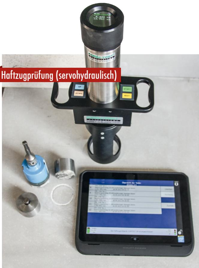
Prüfung der Oberflächenzugfestigkeit nach DIN EN 13813 - digitale Auswertung über Tablet-PC
