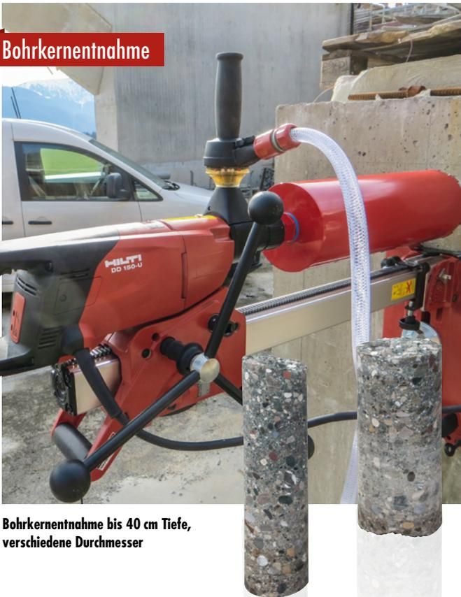
Bohrkernentnahme bis 40 cm Tiefe, verschiedene Durchmesser
