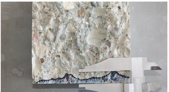
Ermittlung der Wassereindringtiefe und Erstellung eines Prüfprotokolls
