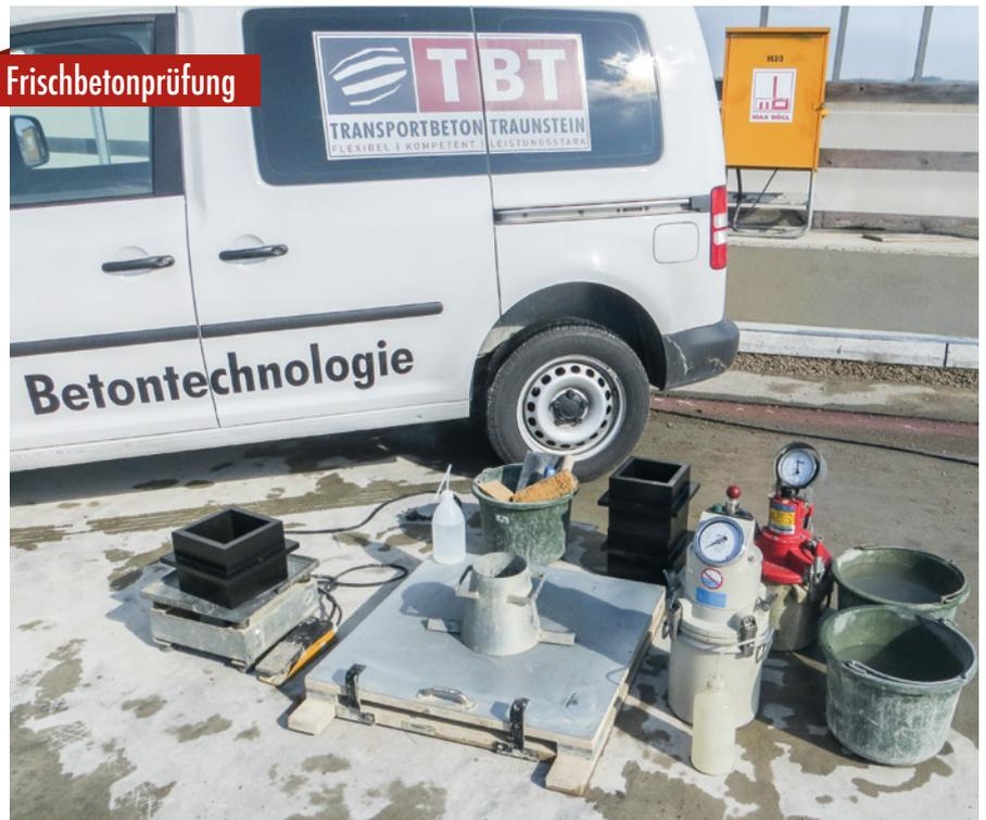
Prüfung von Konsistenz, Rohdichte, Temperatur und Luftporengehalt
