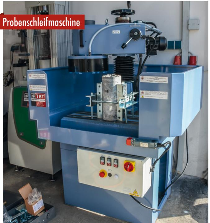
Schleifen und Polieren von Betonprüfkörpern, Natursteinen und keramischen Materialien
