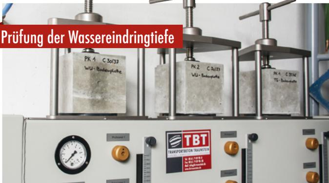
Prüfvorrichtung zum Aufbringen von Wasserdruck, DIN EN 12390-8
