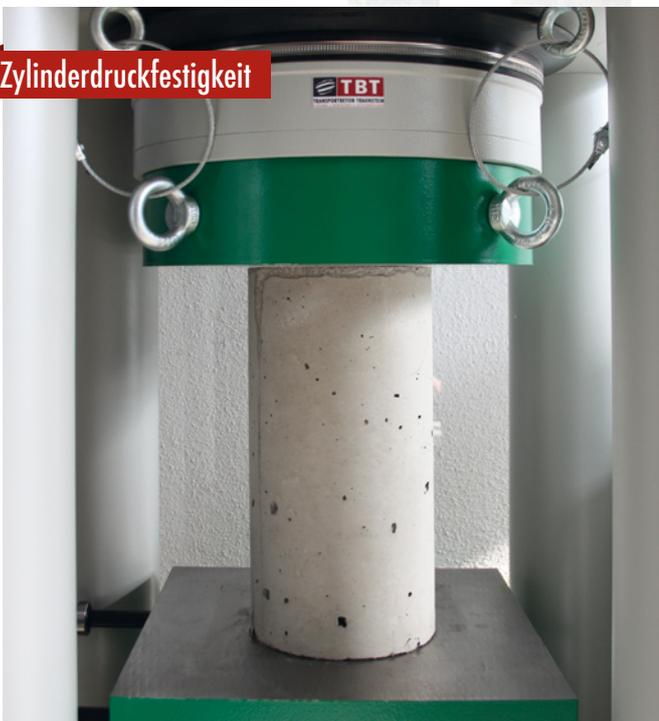
Ermittlung der Zylinderdruckfestigkeit
